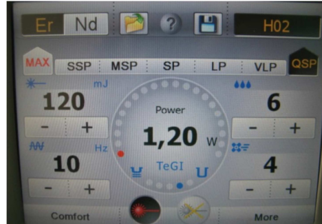
Fig 2: Parameter settings for enamel modification (Case 1).
